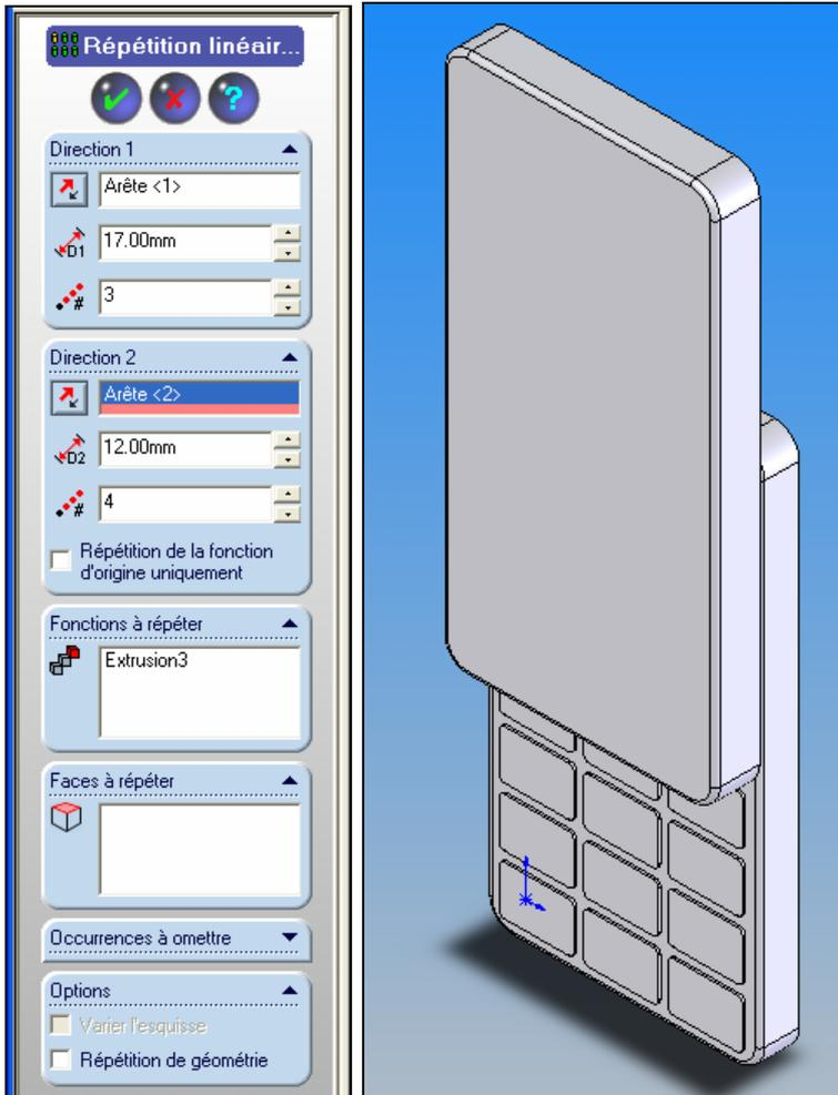
Réalisation de l'écran – Extrusion par enlèvement de matière 1 mm
