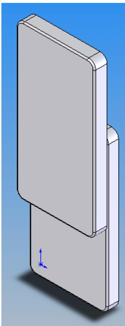
Réalisation du clavier – extrusion de la touche = 0,5 mm
